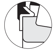
Fig. 2. La battuta di supporto è in contatto con la faccia grande del cono (o anello interno), al di sotto della tenuta.
