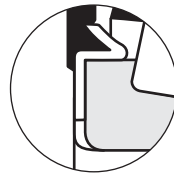
Fig. 1. La battuta di supporto è in contatto con la faccia posteriore della tenuta.
