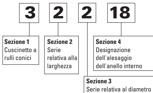
Fig. 30. Sistema di numerazione originale ISO.
