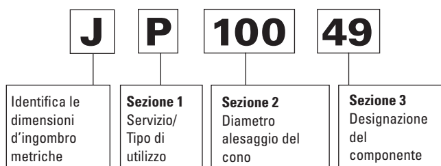
Fig. 28. Sistema di numerazione componenti della serie J-line.
