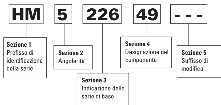
Fig. 26. Nomenclatura del sistema di numerazione ABMA in pollici
